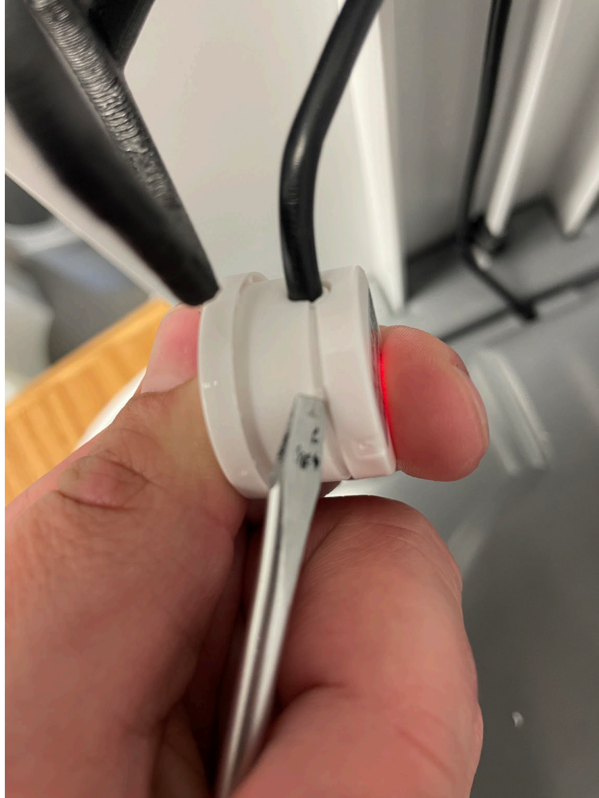
Rückseite des Sensors mit Schraubenzieher entfernen
